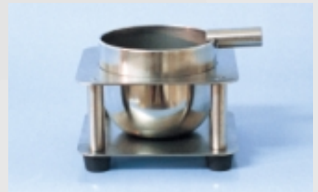
Kathodenbecher aus Edelstahl für die Messung an Drähten und Kleinteilen
