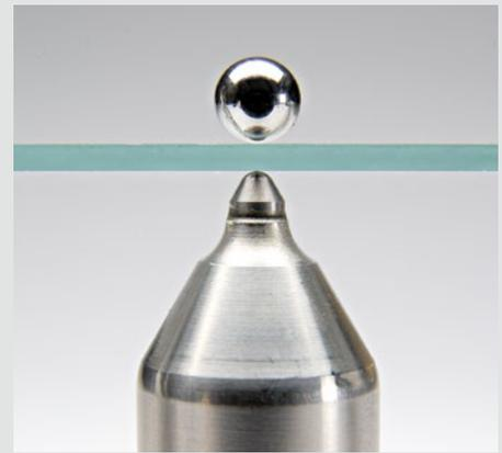
Speziell behandelte Referenzstahlkugeln zur Sicherstellung einer maximalen Reproduzierbarkeit der Messwerte
