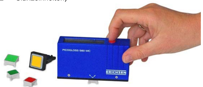
PICOGLOSS 560 MC-S - Glanzmessung auf Kleinteilen
