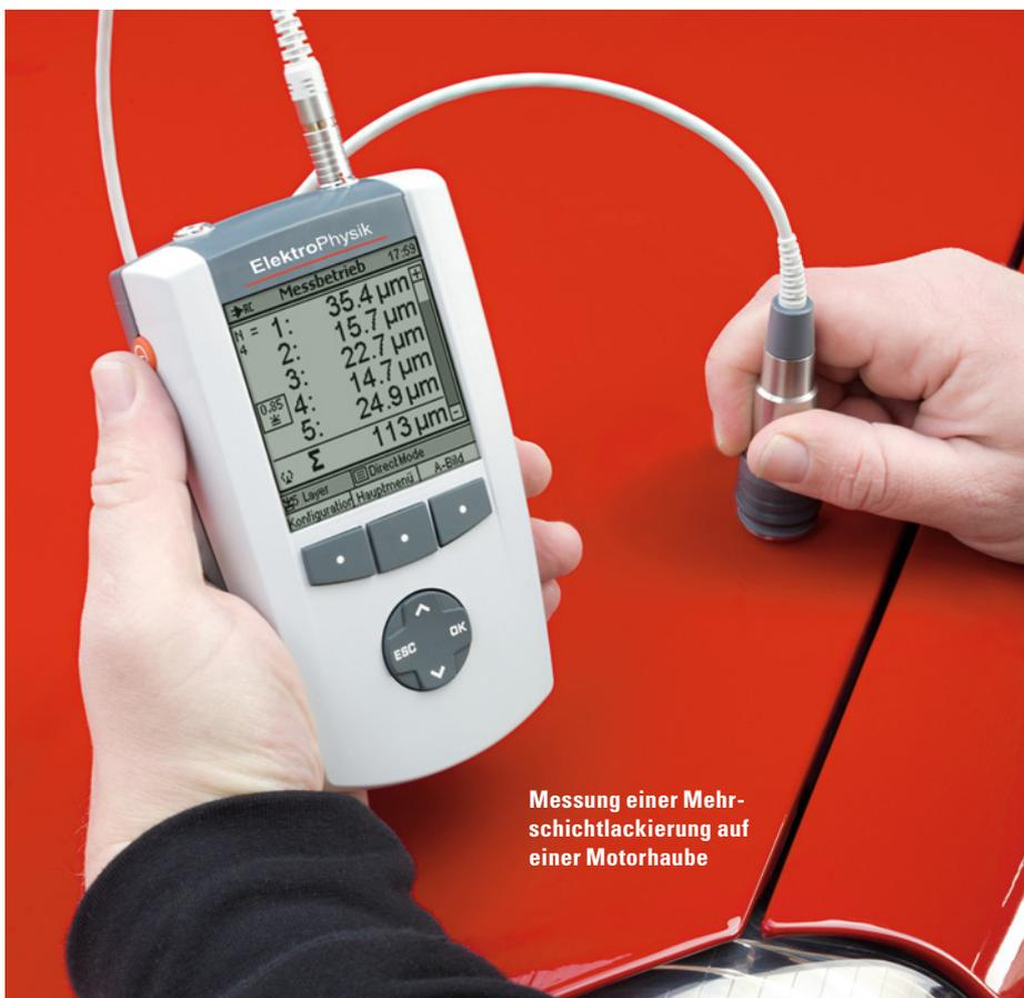
Messung einer Mehrschichtlackierung auf einer Motorhaube
