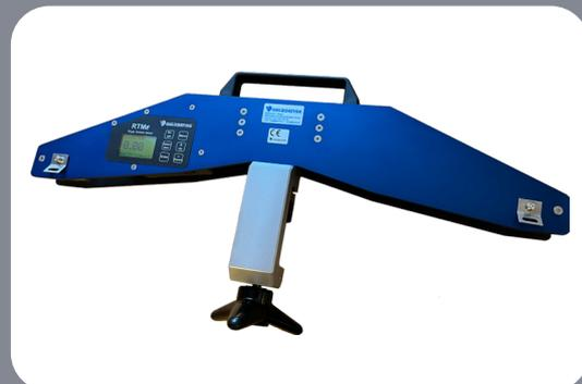
Der PIAB RTMe ist ein auf einem Mikroprocessor aufgebautes Seilkraftmesser zur genauen Bestimmung von Kräften in belasteten Seilen, wie Abspannseilen, Fahrdrähten und Tragseilen.
