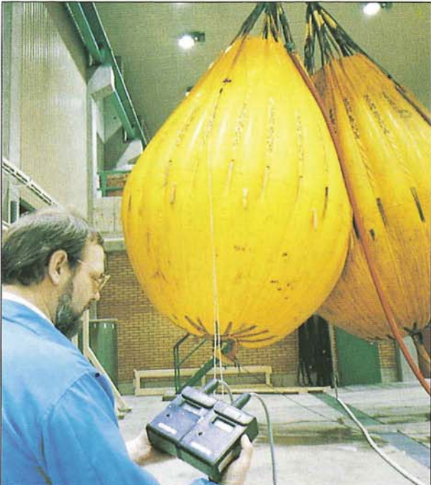
Belastungsproben von Überlastsicherungen mit Wassergewichten (Water Weights). Die Ablesung erfolgt an einem PIAB Lastanzeigergerät.
