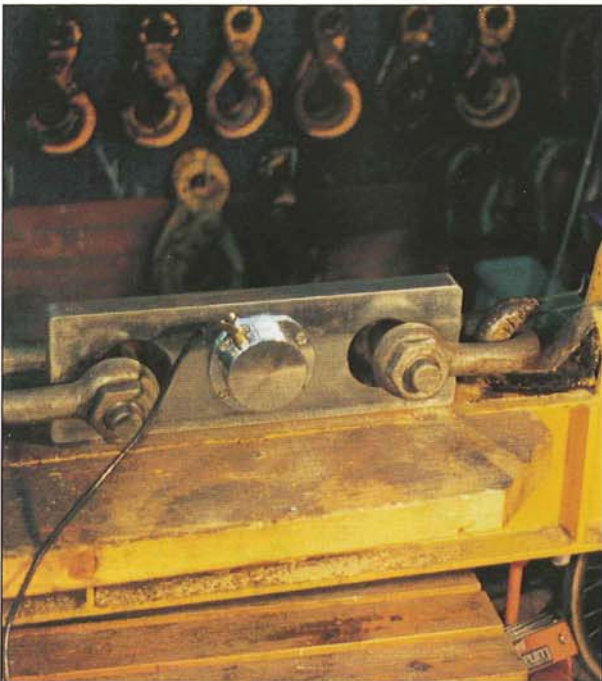
Prüfung von Hebevorrichtungen bei Halmstad Hamn & Stuveri AB.
